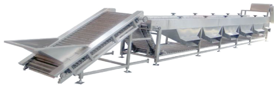
图 4 净制、切制、干燥联动装备样机
