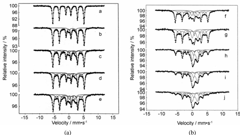
**Fig.1** Mössbauer spectra at room temperature of the samples Fe/PTFE mixture milled for a) 0 h, b) 50 h, c) 70 h, d) 100 h, e) 140 h, f) 200 h, g) 250 h, h) 300 h, i) 350 h, j) 400 h.
